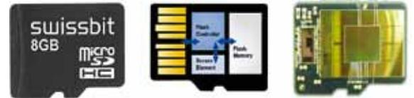
Die Funktion eines TPM übernehmen Swissbits industrietaugliche SD- und µSD-Karten mit Secure Element und spezieller Firmware.
